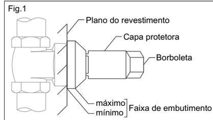
2. Para testar o encanamento, acione o **registro** utilizando a **borboleta** da **capa protetora**.
