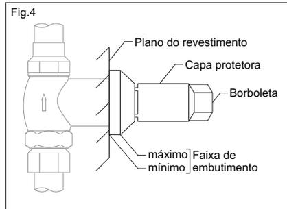
3. Para testar o encanamento, acione o **registro** utilizando a **borboleta** da **capa protetora**.
