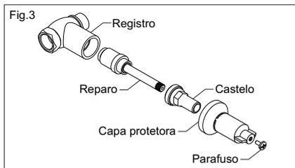
1. Monte o **registro** de modo que a direção da flecha marcada no corpo coincida com a direção do fluxo d'água.
